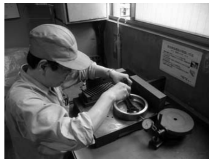
ベアリングの矯正作業：治具を駆使して限りなく真円度に近づける
