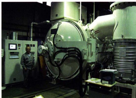
▲最近設置した真空熱処理炉の前で
